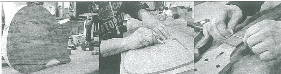
LA LAVORAZIONE La costruzione della chitarra inizia dalla scelta del legno, fondamentale per il tipo di suono che si vuole ottenere. Si parte dalla costruzione del telaio poi si inseriscono le tastiere. Sotto Fabrizio Paoletti, che realizza tutte le sue chitarre a mano
